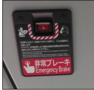
(写真 25)貸切バス・ドライバー異常時対応システム〔EDSS〕
