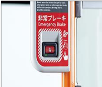
(写真 26,27)乗合バス・ドライバー異常時対応システム〔EDSS〕搭載
